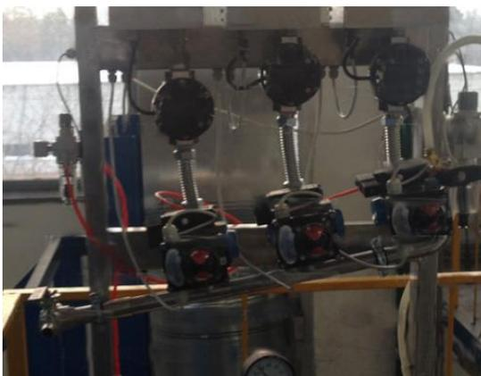
Станция КОНТУР Х550 - промышленный дозатор жидкостей. Станция предназначена для дозирования жидких компонентов в потоке. Применяется на хлебозаводах, на предприятиях химической промышленности (резинотехника).
