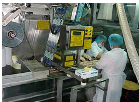
Станция дозирования шестиканальная КОНТУР С530–6 предназначена для подачи жидких компонентов (масло, соус, маринад т.п.) в многоместную упаковку на термоформовочных машинах (ТФМ). Входит в состав технологических линий по производству соков, молочных продуктов и других изделий, а также пресервов и консервированной продукции с использованием оригинальных рассолов и заливок.
