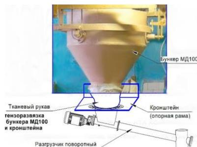
Мукомеры МД-100/200 - "лёгкая" модернизация. Комплект КОНТУР Х17 позволяет за короткое время модернизировать мукомер, путём замены механической рычажной системы с балансирным уравниванием на тензометрическую. Модернизация производится почти без остановки производства, не снимая мукомера с рамы.
