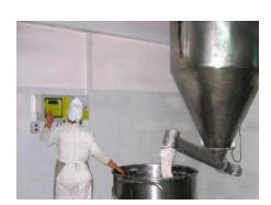
Дозирование производится в два этапа: сначала осуществляется набор и взвешивание сыпучего компонента в накопительном бункере, затем производится разгрузка накопительного бункера в дежу в соответствии с заданным рецептом при помощи разгрузочного устройства.
