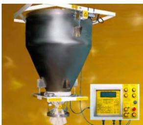
Дозатор сыпучих продуктов с микропроцессорным управлением является современным весовым измерительным комплексом с автоматической разгрузкой бункера и предназначен для порционного взвешивания муки, а также других легкосыпучих и рыхлых компонентов.
