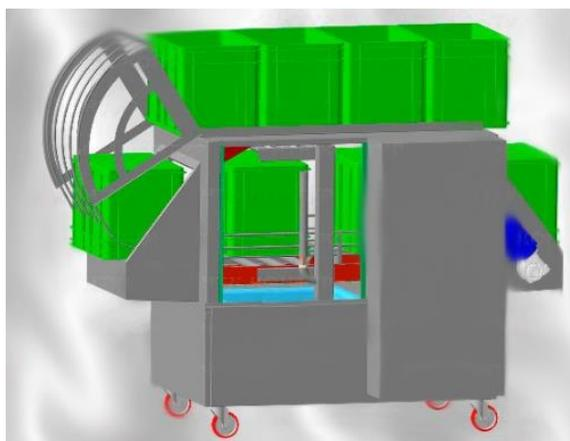
Машина МТ945, младшая, бюджетная модель в линейке моечных туннельных машин. Может применяться на производствах хлебопекарной, кондитерской, рыбоперерабатывающей, молочной, овощной промышленности. Машина рассчитана на универсальные штабелируемые пластиковые ящики, деревянные лотки. Максимальный размер тары (Д\*Ш\*В) 740\*465\*420 мм.
