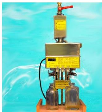
Установка может использоваться в режиме индивидуального полуавтоматического розлива или встраиваться в автоматические конвейерные линии.
