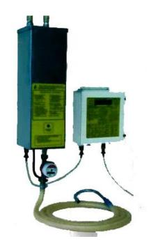
Работа Установки основана на классическом принципе: автоматическое смешивание в потоке (в пропорциях, обеспечивающих заданную температуру) горячей и холодной воды, а затем дозирование воды нужной температуры с помощью крыльчатого или электромагнитного расходомера.
