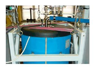
В основе работы Установки лежит принцип тензометрического взвешивания горячей воды, дозирование осуществляется путем вытеснения кипятка сжатым воздухом.
