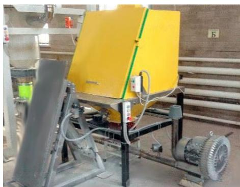
Ручной растариватель предназначен для механизации процесса растаривания мешков с мукой с аспирацией зоны растаривания и последующей выгрузкой в систему бестарного хранения муки.
