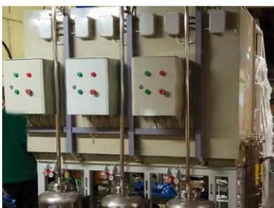
Установка предназначена для производственного хранения сменного запаса пищевых полуфабрикатов солевого раствора (плотностью 1,19), сахарного раствора (плотностью 1,3) и растительного масла (плотностью 0,92).
