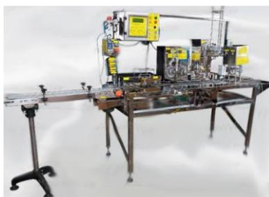
Основные механизмы и узлы машины обеспечивают выполнение последовательных операций: взвешивание банок с продуктом, отбраковку банок по весу, дозирование сыпучих специй, дозирование жидких компонентов в банки, выдачу крышек, преукупорку и укупорку готовых банок.
